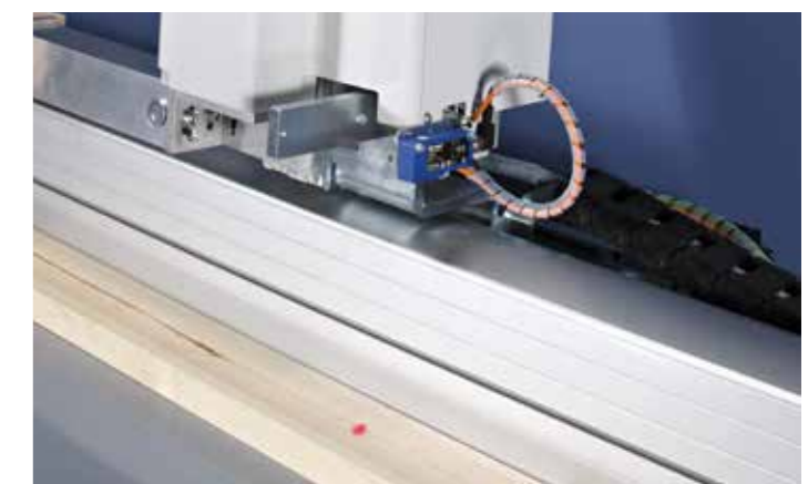
Detail des Schiebers mit Messsensor des Werkstücks.
